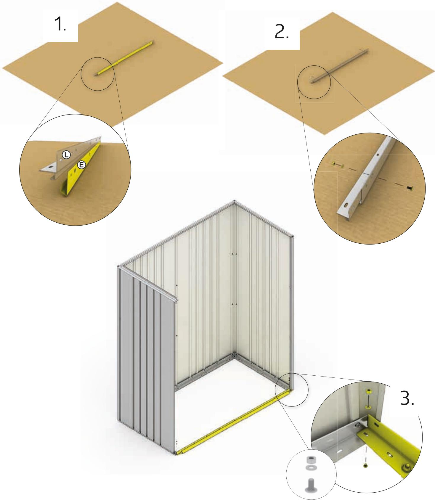
Størrelsesavhengig monteringstrinn! - Sposób montażu zależy od wielkości. - Montážny krok závislý od veľkosti! - Korak montaže odvisen od velikosti! - Montážní krok závislý na velikosti! - Mérettől függő összeszerelési lépés! - Korak sklopa ovisno o veličini! - Pas de asamblare in functie de marime
